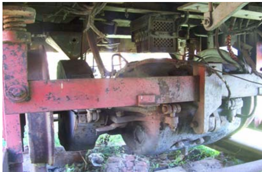
Fig. 3. Osia montată și motorul de tracțiune.
